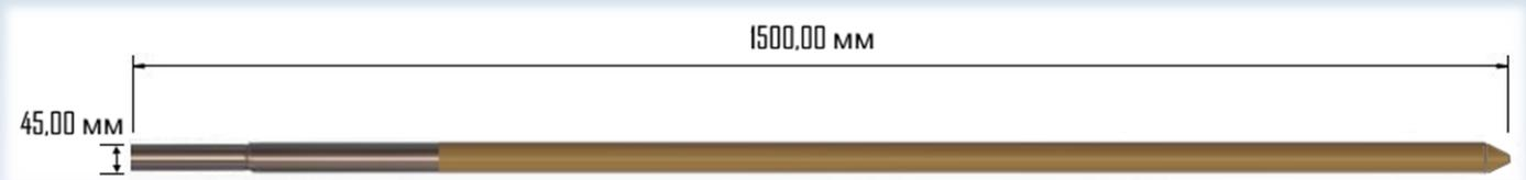
Скважинные зонды, используемые для определения магнитной восприимчивости, основаны на электромагнитной
